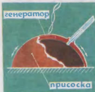
ские колебания преобразуются в механические. Кварцевая пластинка начинает то расширяться, то сокращаться. Частота механических колебаний зависит от частоты электрических колебаний, а потому может регулироваться водителем бионической машины.
