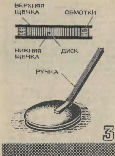
каркасе из изоляционного материала, который затем помещают в карбонильный сердечник СБ-4 (рис. 2). На каркас вначале наматывают катушку L6 — 260 витков с отводом от 60-го витка, считая от верхнего по схеме вывода. Далее наматывают катушку L5 — 40 витков и в последнюю очередь — катушку L4 (2 витка). Чтобы удобнее было вращать подстроечный сердечник, для него подбирают ручку настройки.
